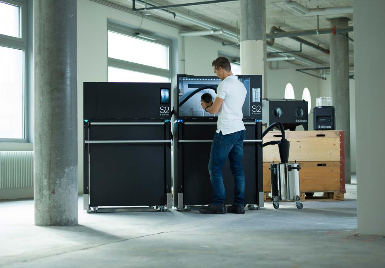
Ergonomische Systemlösung für den professionellen 3D-Druck: Die Sintratec S2 besteht aus drei Hauptmodulen und ist mit mehreren Zusatzmodulen beliebig erweiterbar.
