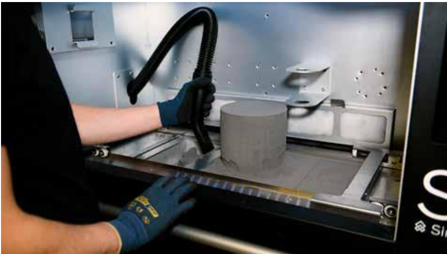
Der Entpulverungsprozess in der Material Handling Station (MHS) erfolgt auf ergonomisch idealer Höhe. Nicht gesintertes Pulver wird abgesaugt und gesiebt, um wiederverwendet zu werden.
