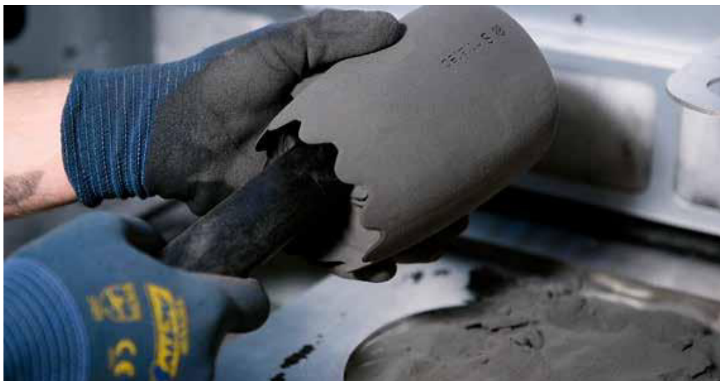
Entpulverungsprozess eines dünnwandigen, aber trotzdem äußerst stabilen Turbinengehäuses aus dem Material Sintratec PA12 . (Alle Bilder: Sintratec AG)
