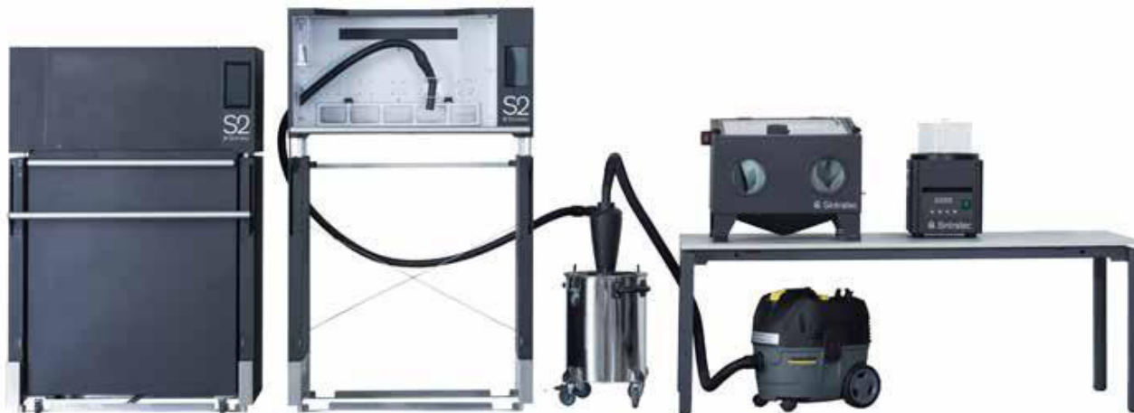
Die Sintratec S2 besteht aus mehreren Modulen: ganz links die Laser Sintering Station (LSS) und die Material Core Unit (MCU) und als höchstes Modul die Material Handling Station (MHS). Zusätzlich erhältlich sind die Blasting Station, die Polishing Station (beide rechts auf dem Tisch) und die Sintratec Vortex Unit (unten).
