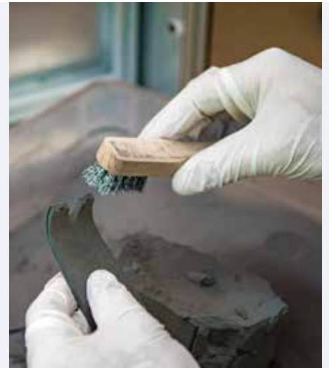
Entpulverung der ersten SLS-Teile
